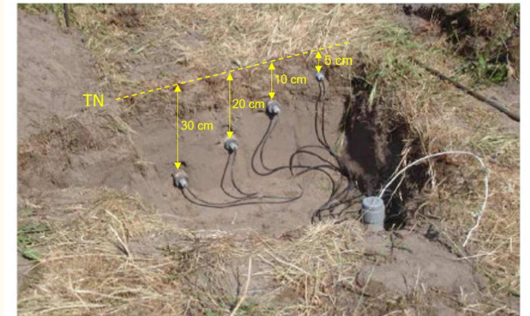
Sondes ThetaProbe ML3/ML2X après installation dans l'une des stations SMOSMANIA à 4 profondeurs (5, 10, 20 et 30 cm)
